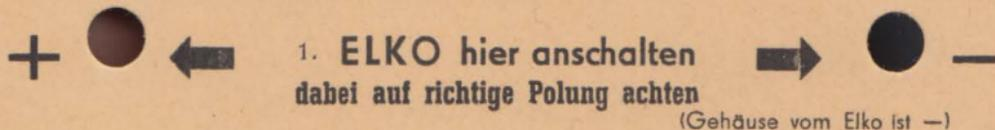
Gütebeurteilung: Ein Elko schlägt selten durch, es wird nur der Reststrom höher. Zeiger darf bei gutem Elko nur bis zu dem unten angegebenen, nach  $\mu\text{F}$  bezifferten Wert gehen.
